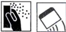
Il est nécessaire de procéder à une préparation de la surface à l'aide de mastics en poudre ou en pâte. Après 12 heures de la fin d'application poncer à l'aide de papier abrasif, il est conseillé d'utiliser un grain type P120. Une fois le ponçage terminé, il faut éliminer d'éventuelles traces de saleté et poussières et procédez à l'application au moyen d'un rouleau 2 couches de FIXATEUR LISSE dilué à 5%.
